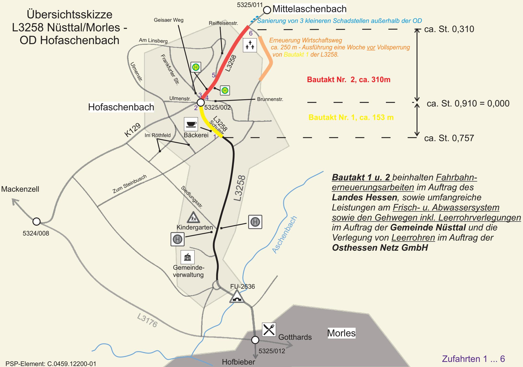
***Bautakt 1 u. 2*** beinhalten Fahrbahn-erneuerungsarbeiten im Auftrag des **Landes Hessen**, sowie umfangreiche Leistungen am Frisch- u. Abwassersystem sowie den Gehwegen inkl. Leerrohrverlegungen im Auftrag der **Gemeinde Nüsttal** und die Verlegung von Leerrohren im Auftrag der **Osthessen Netz GmbH**
